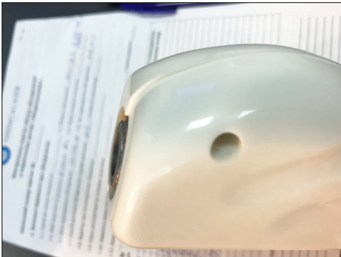
Фото. 5.1. Сдвиг половин корпуса манипулы в результате падения.
