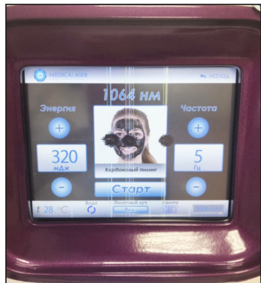
Фото. 4.2. Повреждения дисплея из-за попадания на дисплей лазерного луча – три темных пятна.
