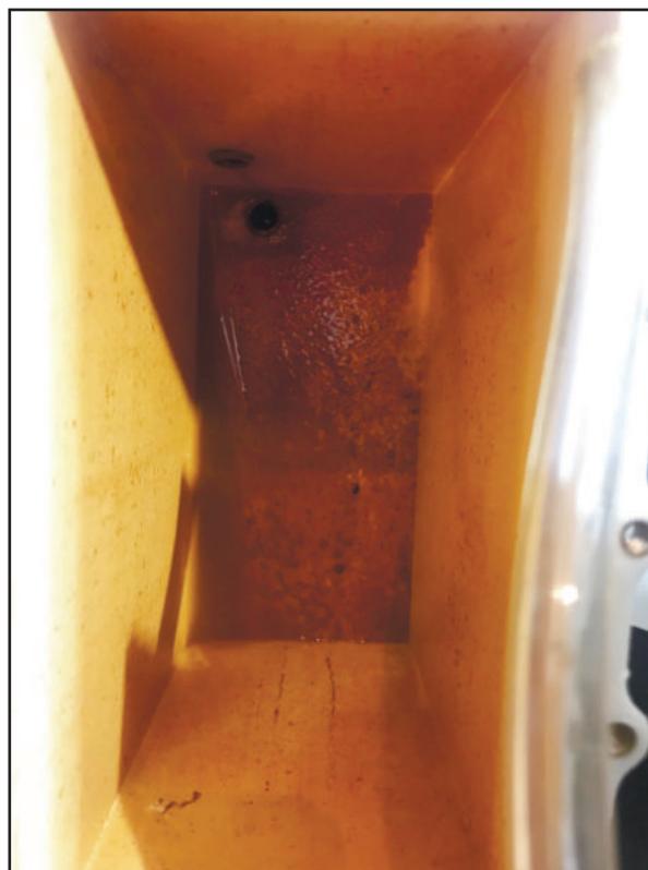
Фото. 1.2. Отложения осадка в баке для воды лазерного аппарата.
