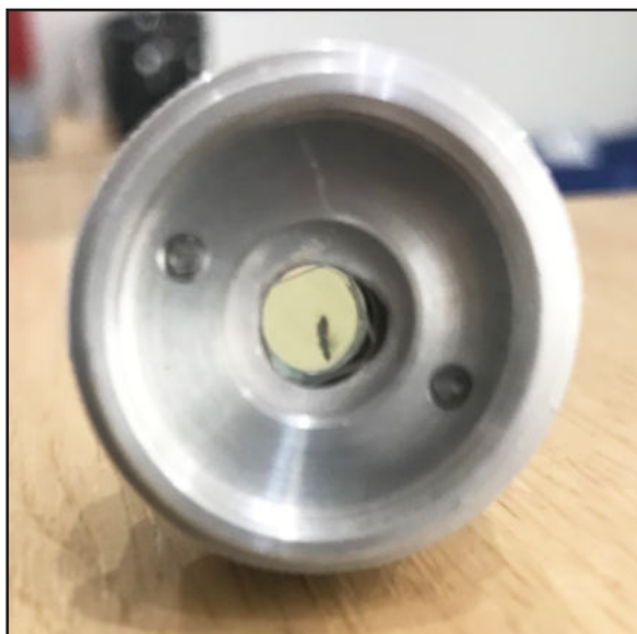
Фото. 4.1. Прогорание насадки (темное пятно на стекле) из-за попадания загрязнителя на поверхность и несвоевременного очищения поверхности.
