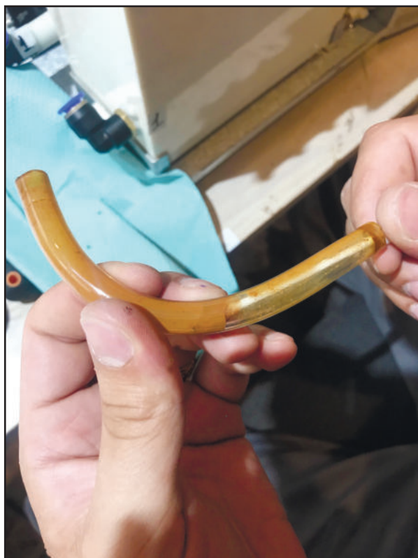
Фото. 1.1. Осаждение кальциевых отложений в патрубке системы охлаждения. Ватной палочкой очищена часть патрубка для демонстрации величины засорения.
