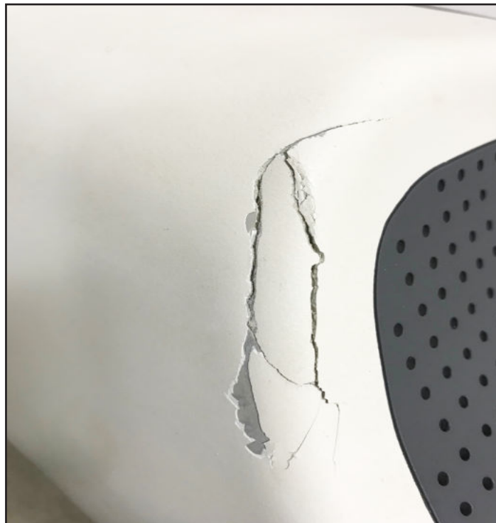
Фото. 7.2. Повреждения левой стороны верхней крышки аппарата.
