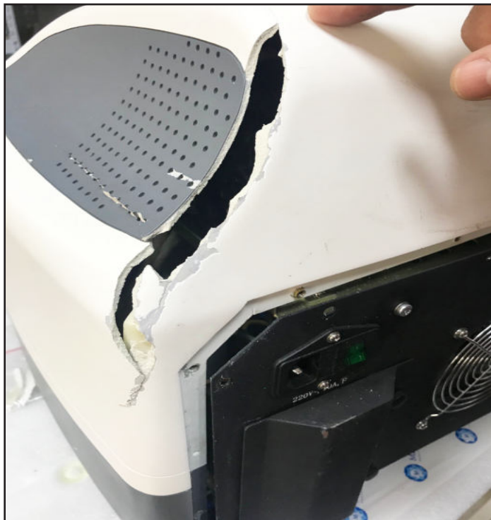
Фото. 7.1. Разрушение правой стороны верхней крышки аппарата.
