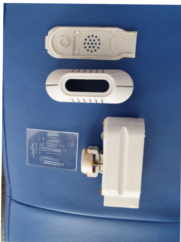
Фото. 11. Разобранный датчик. Рядом находится тестовая пластина, в которой ультразвук создал «линию» - набор последовательных точек воздействия.
