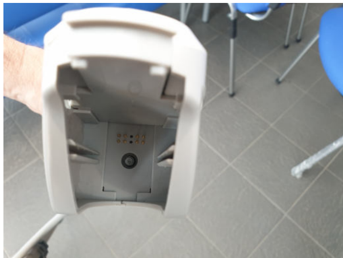
Фото. 10. Вид манипулы со стороны крепления датчика. Виден вал мотора, контактная группа, направляющие для точной центровки датчика.
