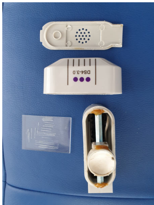
Фото. 12. Направляющий шток в датчике и излучатель ультразвука.
