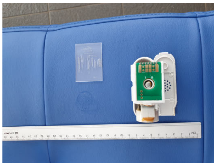
Фото. 14. Контактная группа датчика и шток, который находится в круглом отверстии.
