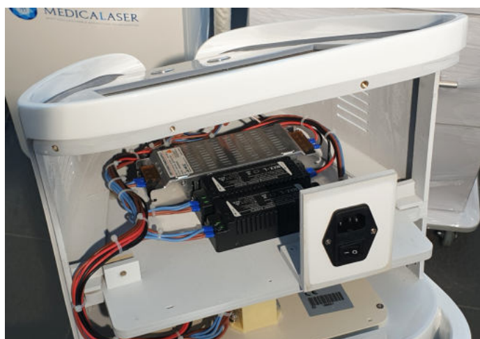
Фото. 7. Три блока питания. Блок питания в защитном перфорированном кожухе, который обеспечивает защиту от электромагнитного излучения.
