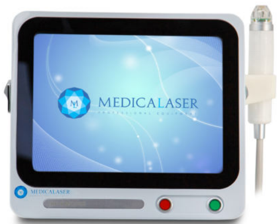
Фото. 1. Корпус аппарата со стороны лицевой панели – дисплей, зеленая кнопка включения аппарата и красный индикатор работы.
