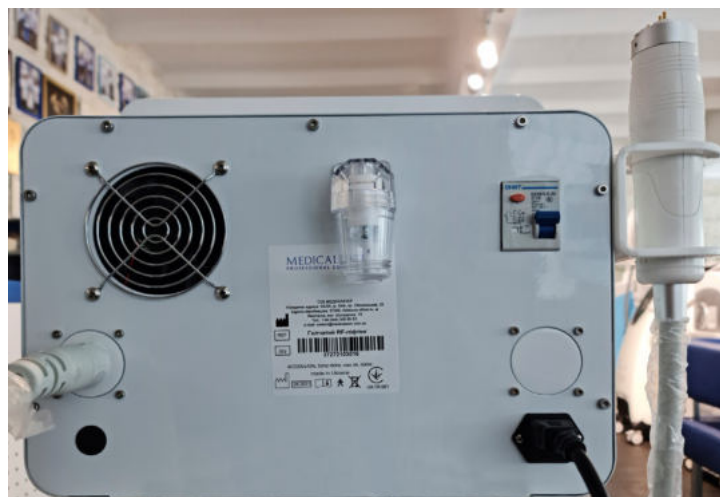
Фото. 2. Корпус аппарата со стороны задней панели. Видны разъем подключения манипулы, отверстие кулера, выключатель и разъем кабеля питания.
