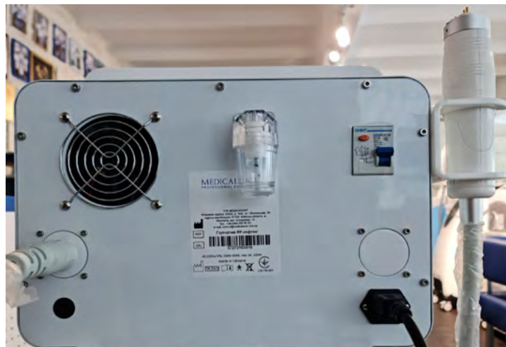
Фото. 2. Корпус апарата зі сторони задньої панелі. Видно роз'єм підключення маніпули, отвір кулера, вимикач і роз'єм кабелю живлення.
