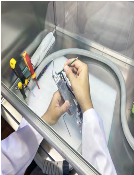
Фото. 9. Складання маніпули неодимового лазера
