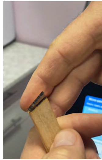
Фото. 3. Шпатель завтовшки 2 мм перерізаний дуже швидко і рівно, краї зрізу гладкі.
