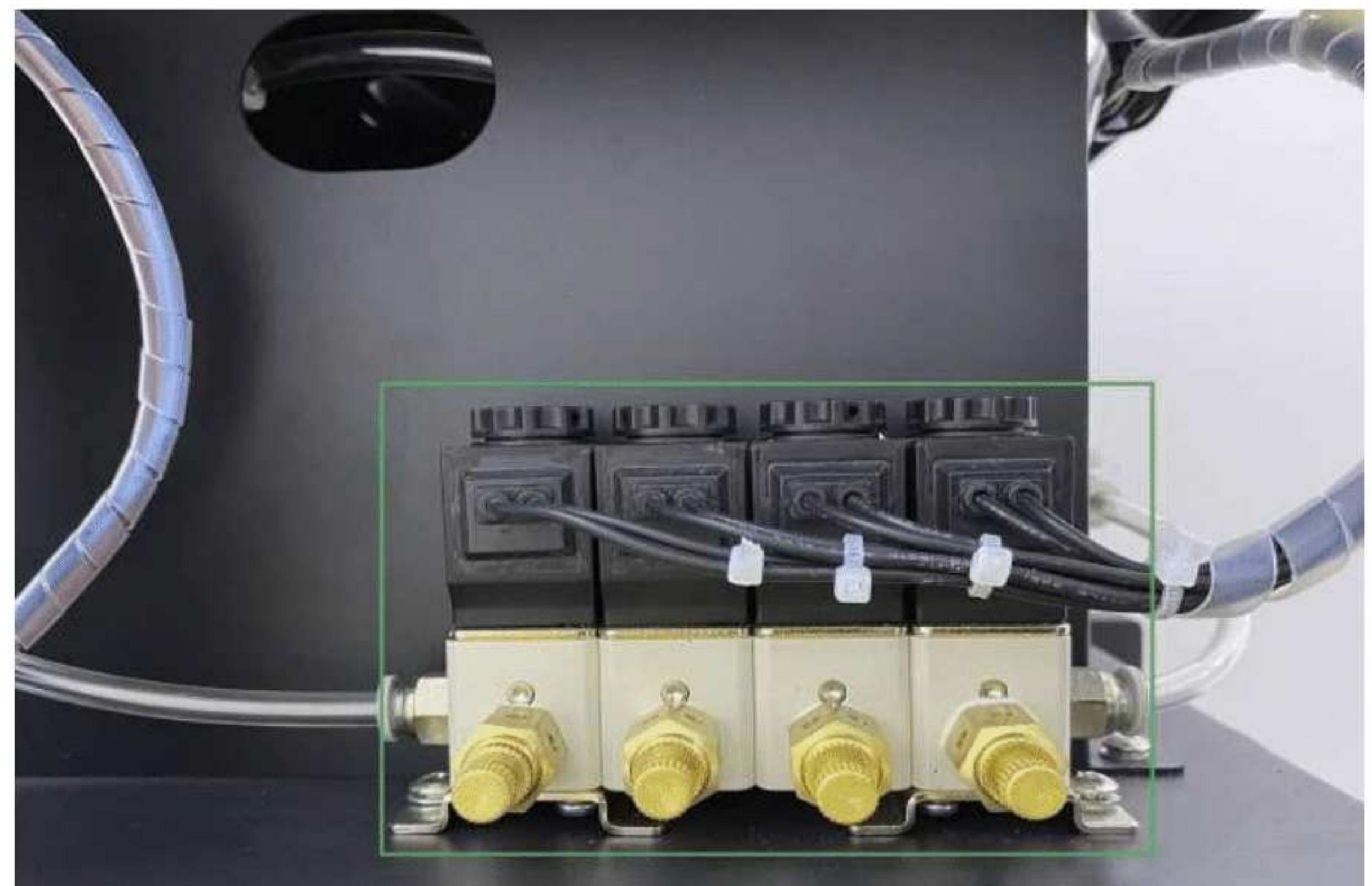
**Фото 8. Реле керування вакуумом.**
