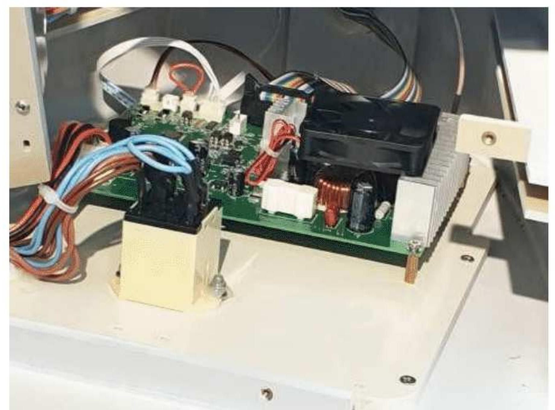
Фото 8. Плата керування генеруванням ультразвуку.
