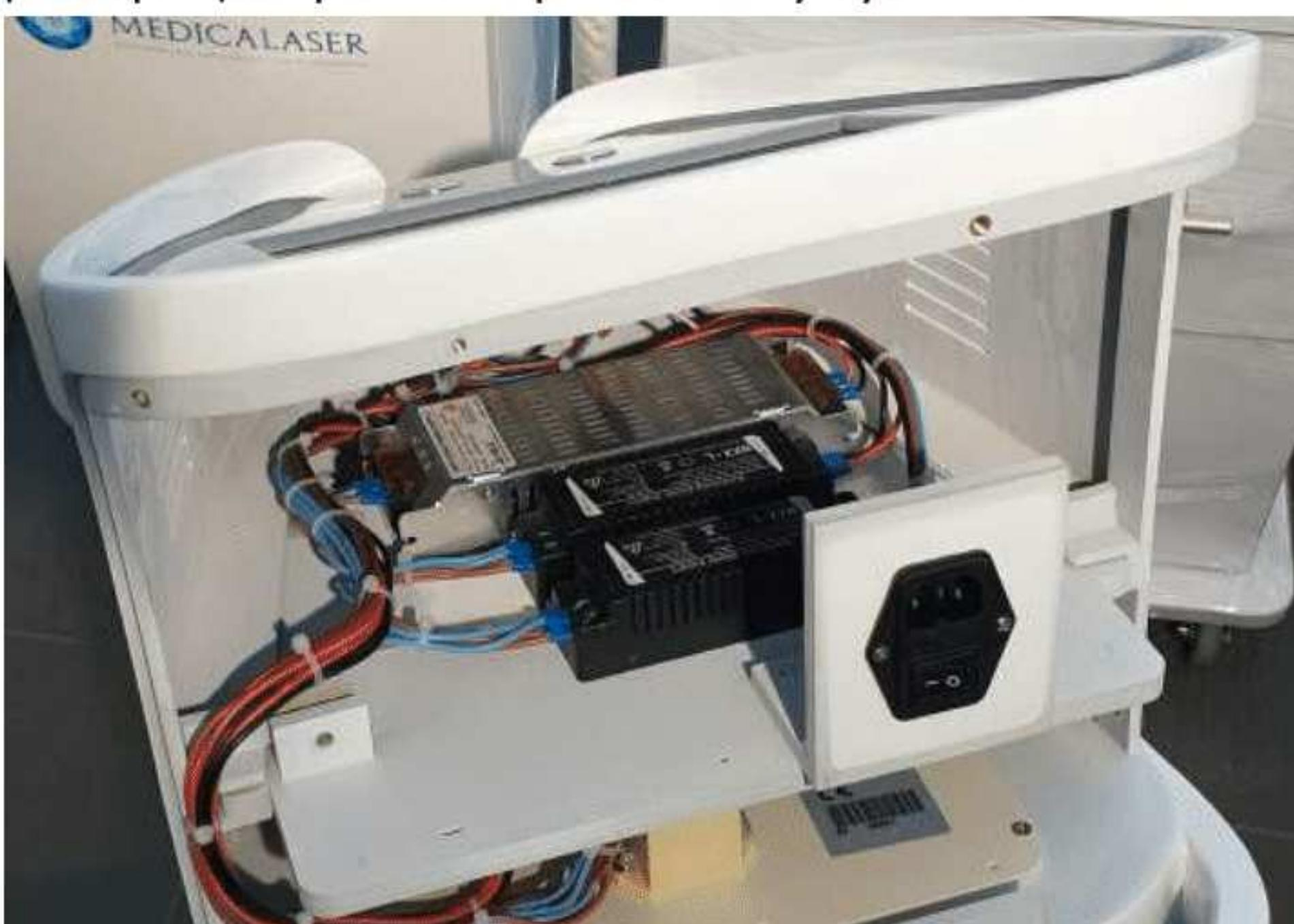
Фото 7. Три блоки живлення. Блок живлення в захисному перфорованому корпусі, який забезпечує захист від електромагнітного випромінювання.
