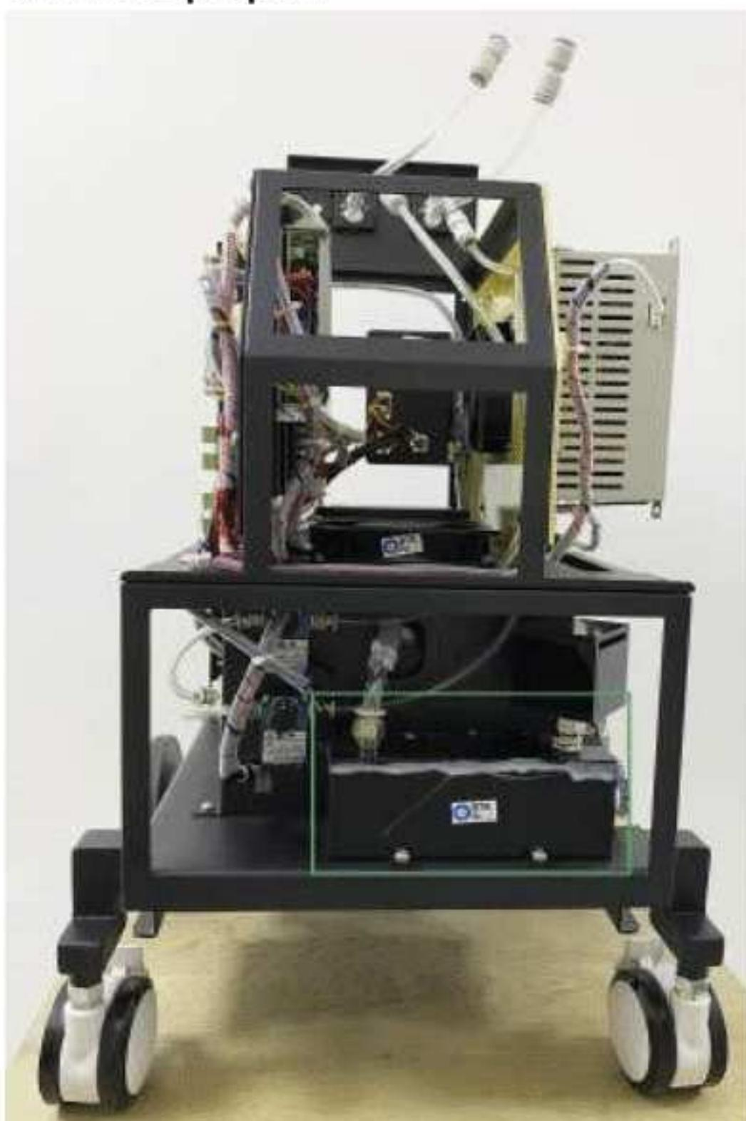
**Фото 7. Захищений компресор, внутрішній фільтр і глушник повітряних коливань.**
