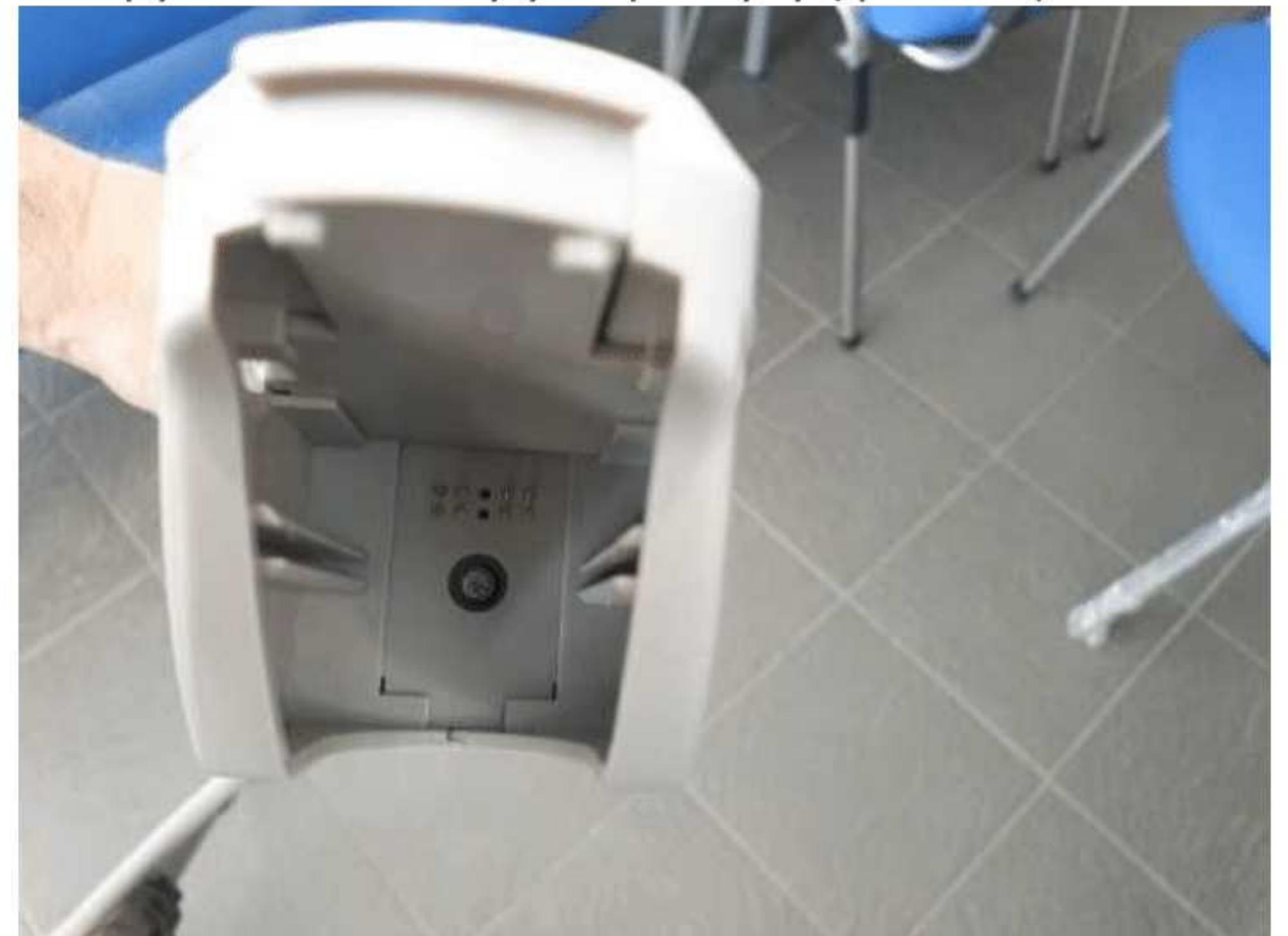
**Фото 10. Вид маніпули з боку кріплення датчика. Видно вал мотора, контактну групу, напрямні для точного центрування датчика.**
