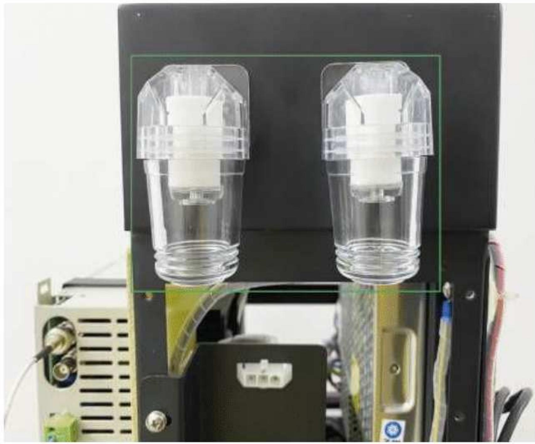
**Фото 9. Зовнішні фільтри, які захищають систему від різних частинок, які втягаються маніпулами під час роботи.**
