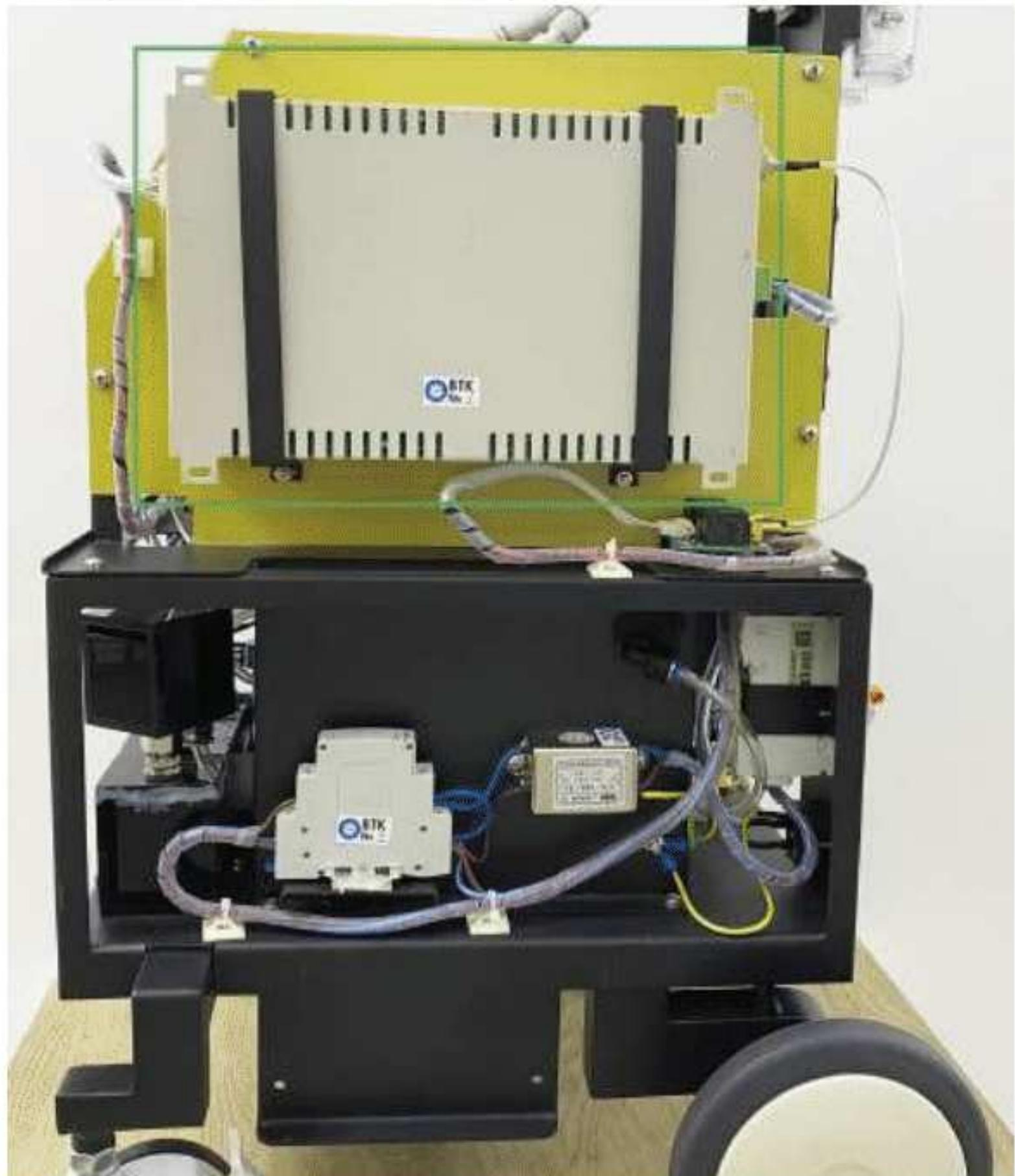
**Фото 11. Блок генерування та керування RF-струмом.**
