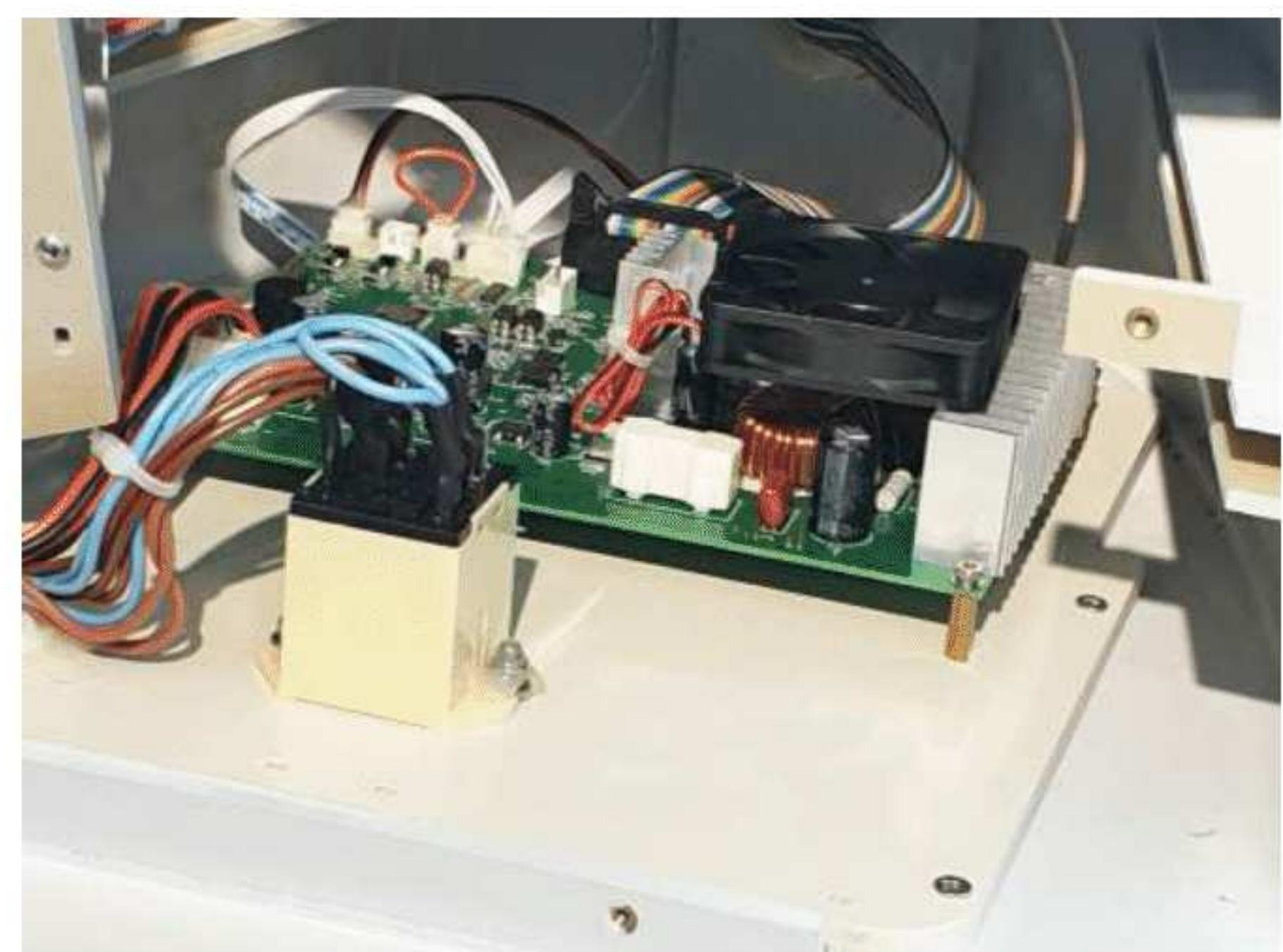
**Фото. 8. Плата управления генерированием ультразвука.**
