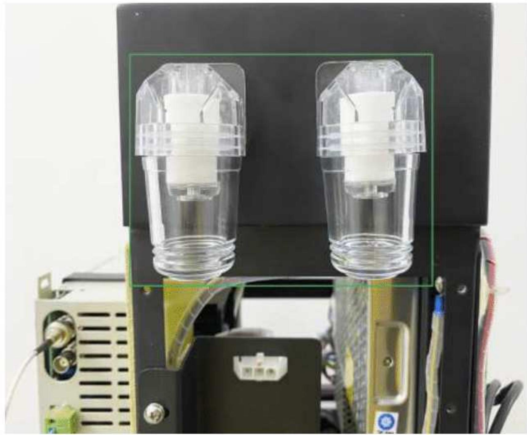
**Фото. 9. Внешние фильтры, которые защищают систему от различных частиц, которые втягиваются манипулами во время работы.**
