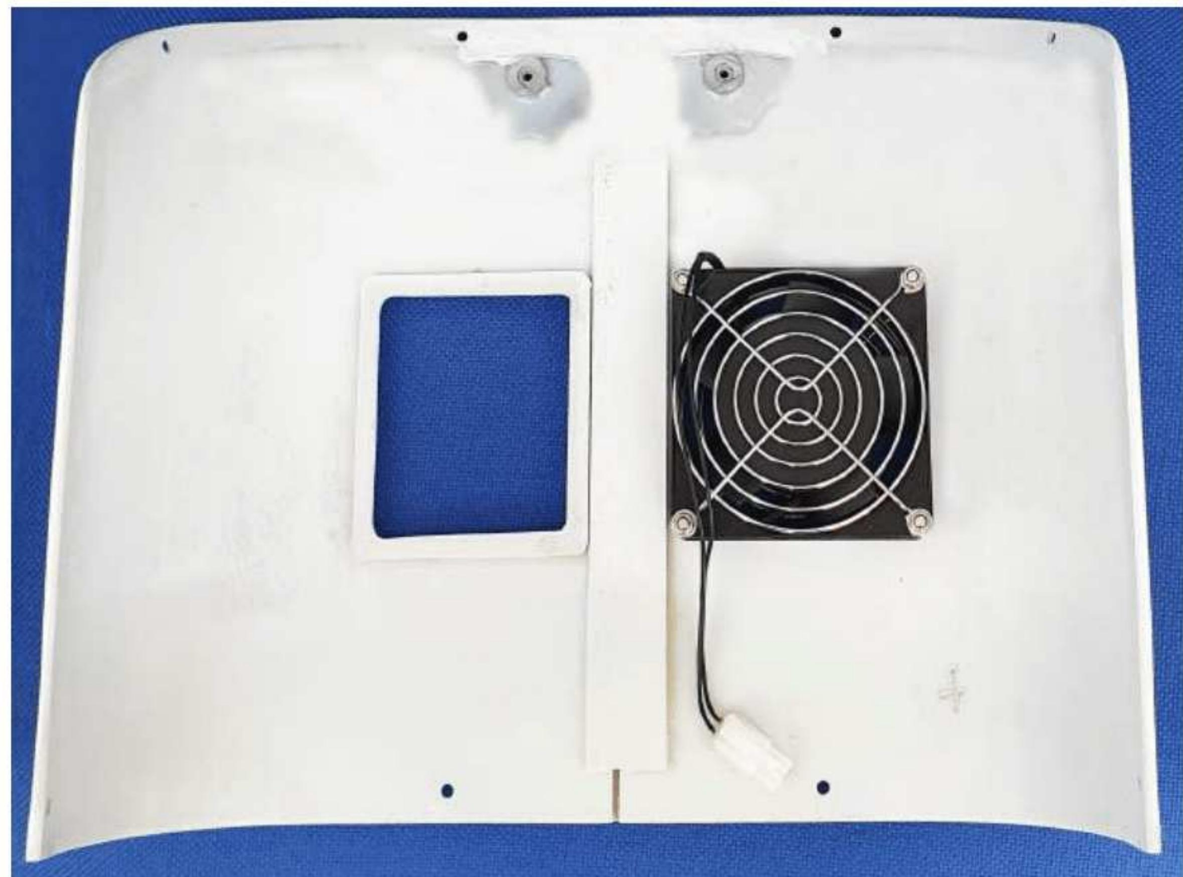
**Фото. 2Б. Элемент системы охлаждения – кулер.**
