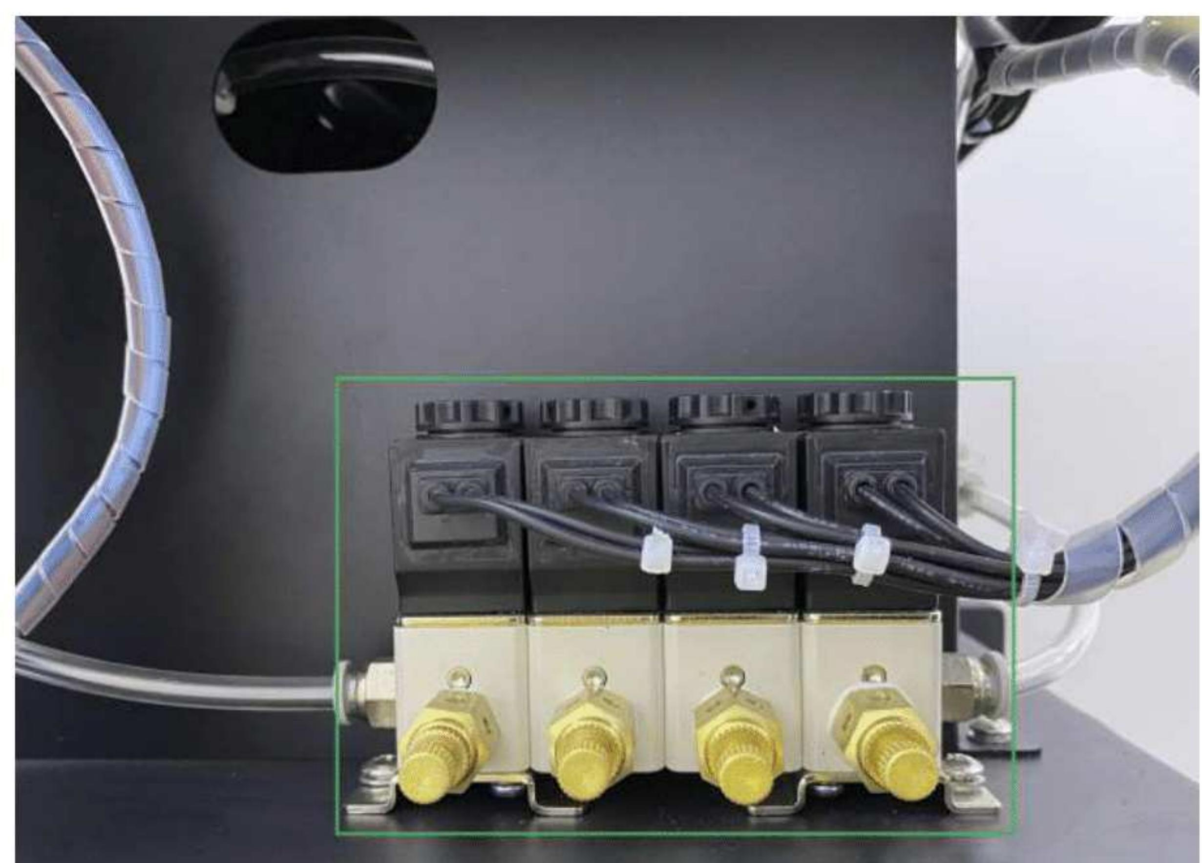
**Фото. 8. Реле управления вакуумом.**
