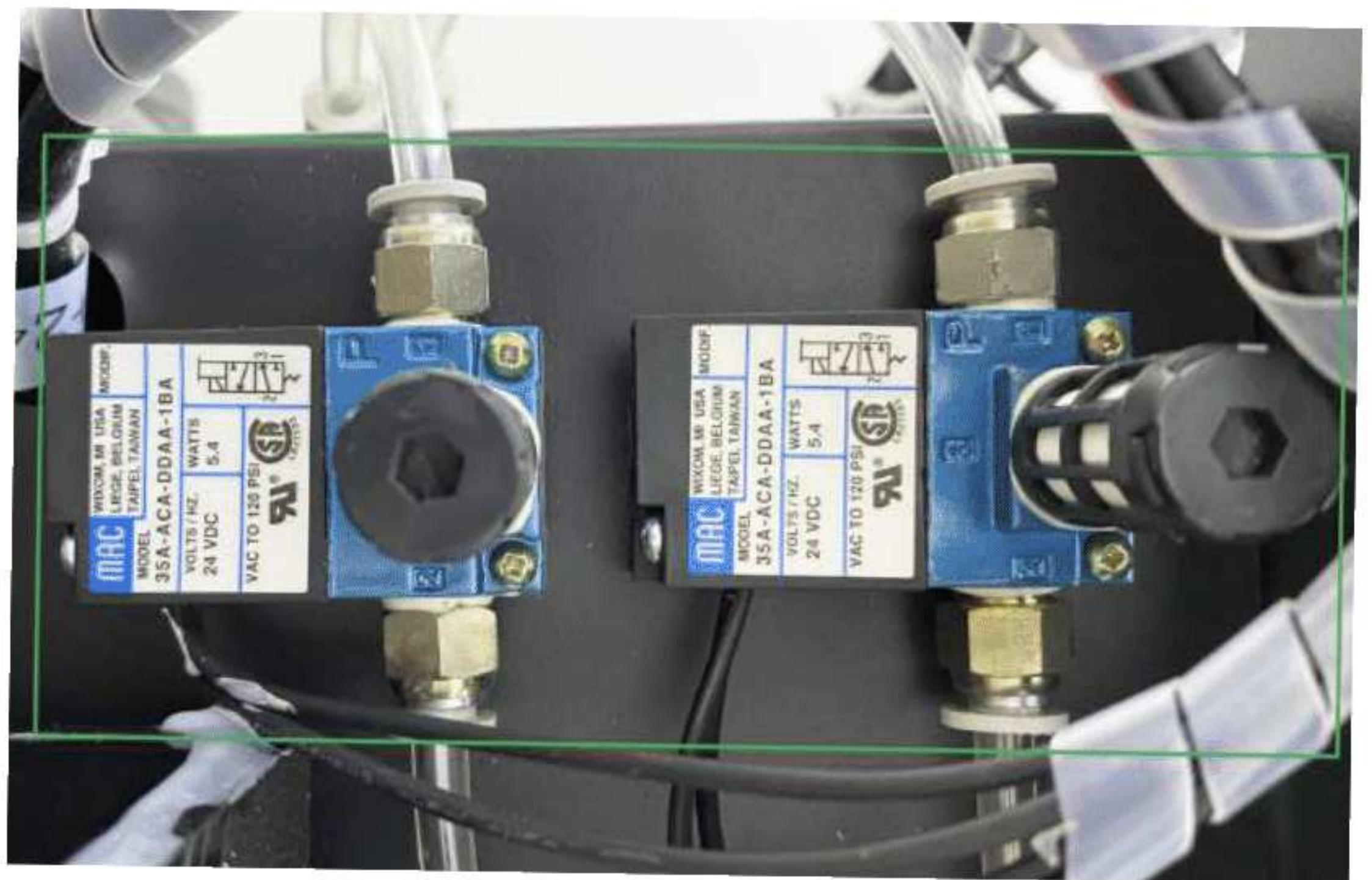
**Фото. 10. Блоки управления вакуумом для переключения вакуума между манипулами.**
