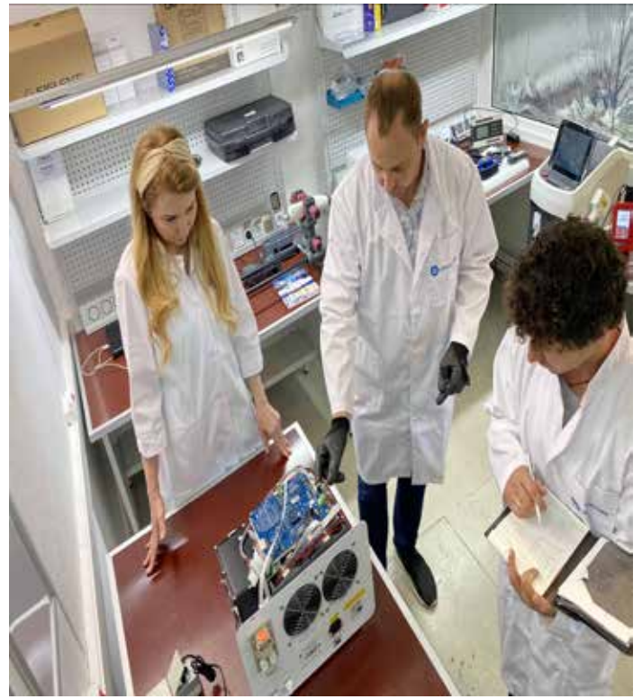
Фото. 11. Лаборатория. Стол для проверки аппаратов под повышенным и пониженным напряжением.
