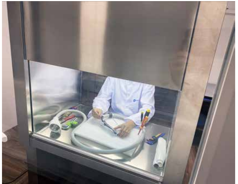
Фото. 7. Беспылевой шкаф для сборки оптики.
